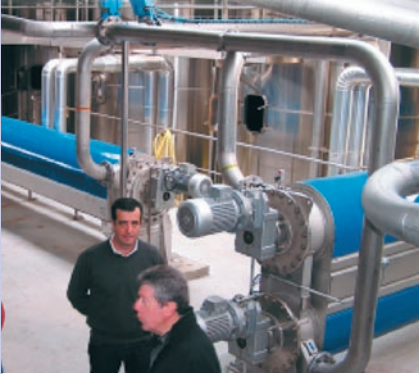
Le nouvel outil de vinification : la vendange passe dans les cylindres bleus, portant sa température de 63 °C à 75 °C. De face : Le directeur général de la cave Pierre Philippe.
